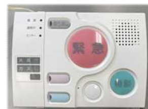
緊急通報装置
