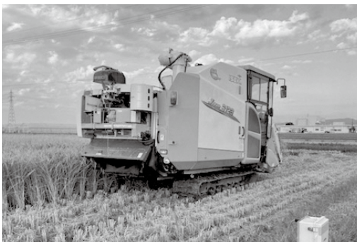
収量水分センサ付コンバイン (収穫しながら収量・水分を測定できる)
