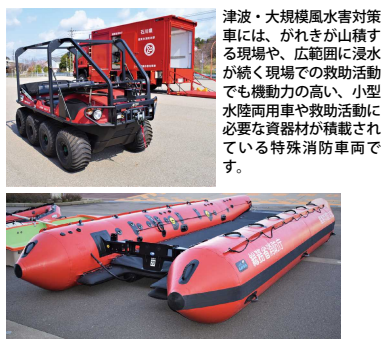
高機能救命ボートは、船底が補強布で保護されているため、がれき等がある浸水域でも活動可能な20人乗りの大型ゴムボートで、多くの要救助者を一度に搬送することや、車椅子に乗ったままの状態でも救助することも可能な高機能ゴムボートとなります。
