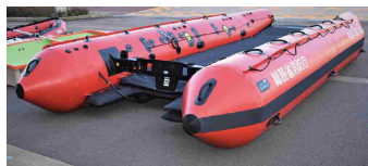
高機能救命ボートは、船底が補強布で保護されているため、がれき等がある浸水域でも活動可能な20人乗りの大型ゴムボートで、多くの要救助者を一度に搬送することや、車椅子に乗ったままの状態でも救助することも可能な高機能ゴムボートとなります。
